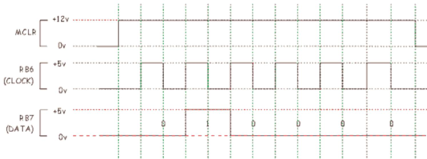
Tutte le operazioni sul PIC da programmare devono essere precedute dall'invio di un comando da parte del programmatore per comunicare al PIC l'operazione che si intende eseguire. La lunghezza dei comandi è sempre di 6 bit a volte seguiti da una trasmissione di 14 bit contenenti il valore da programmare. Nella seguente tabella viene riportato a titolo d'esempio l'elenco dei comandi riconosciuti dai PIC16x84:
