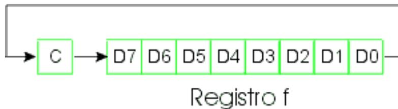
questa lettura avviene per otto volte ad intervalli di tempo pari alla durata di un bit in modo da campionare il valore della linea RX sempre al centro del bit in ricezione.
