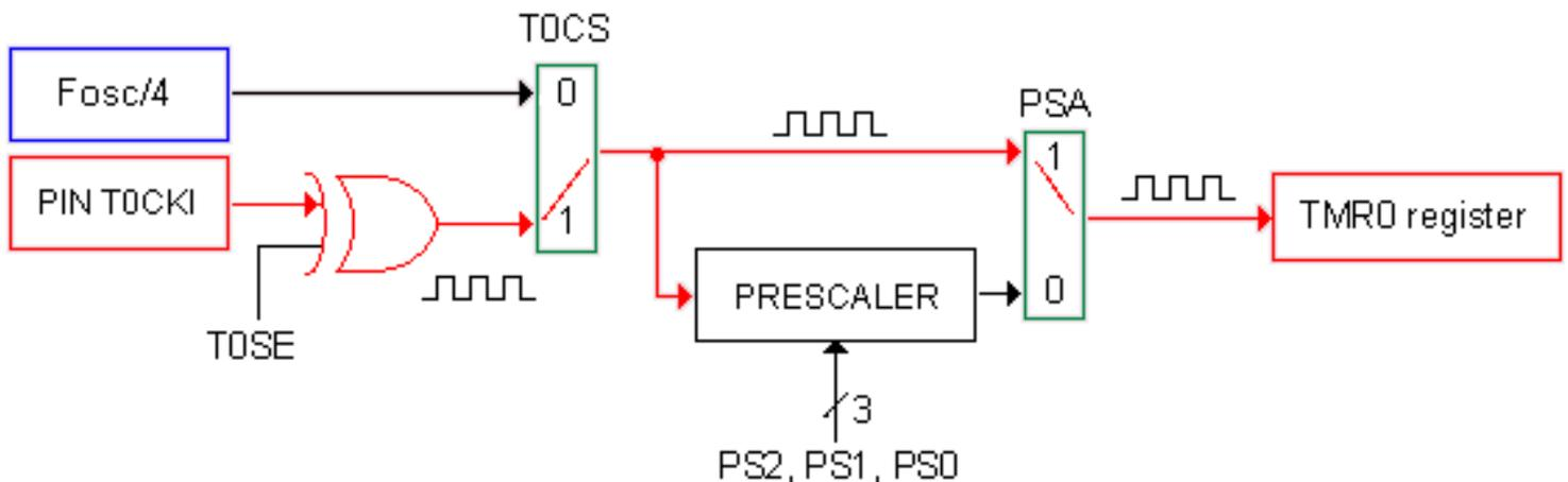
Questa volta sarà il segnale applicato al pin TOCKI del PIC ad essere inviato direttamente al contatore TMR0 determinandone la frequenza di conteggio. Applicando ad esempio a questo pin una frequenza pari ad 100Hz otterremo una frequenza di conteggio pari a cento incrementi al secondo.
