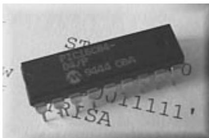
i **PIC** (in questo caso un PIC16C84) si presentano esternamente come dei normali circuiti integrati TTL o CMOS, ma internamente dispongono di tutti i dispositivi tipici di un sistema a microprocessore, ovvero:
