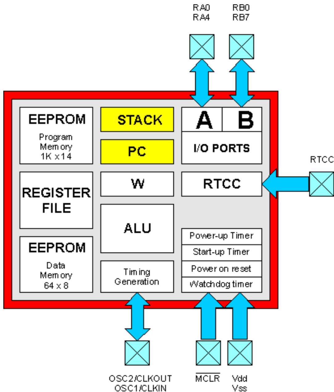
Come abbiamo già visto nei passi precedenti, il PIC16F84 inizia l'esecuzione del programma a partire dal vettore di reset (**Reset Vector**) ovvero dall'istruzione memorizzata nella prima locazione di memoria (indirizzo 0000H).
