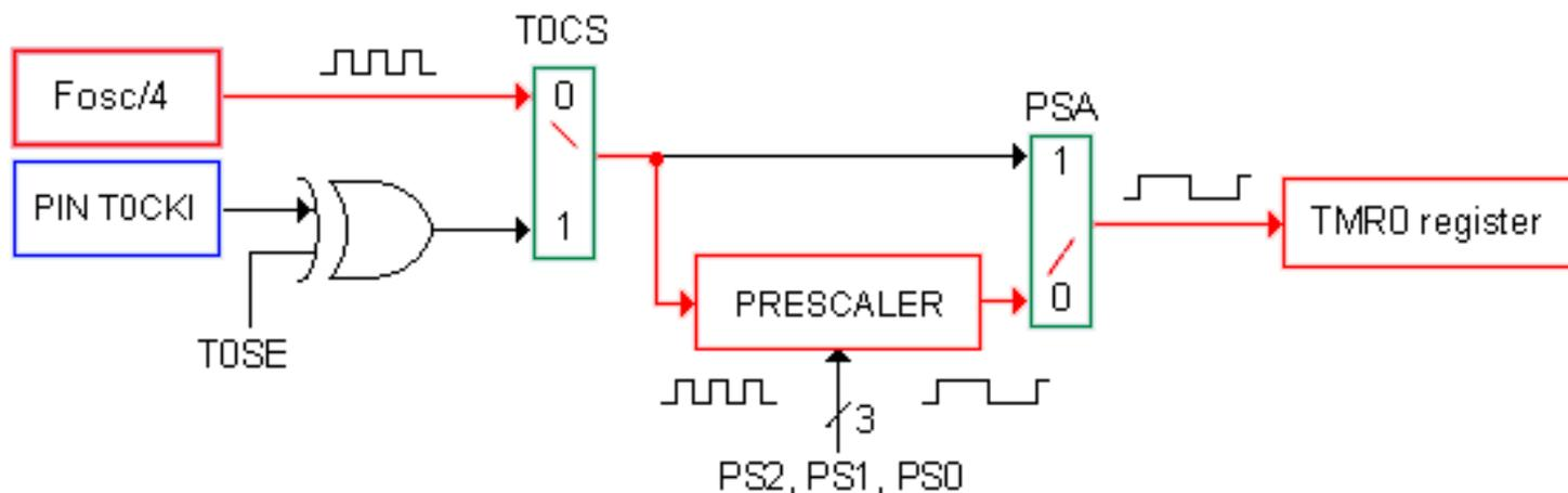
Il PRESCALER consiste in pratica in un divisore programmabile a 8 bit da utilizzare nel caso la frequenza di conteggio inviata al contatore TMR0 sia troppo elevata per i nostri scopi.
